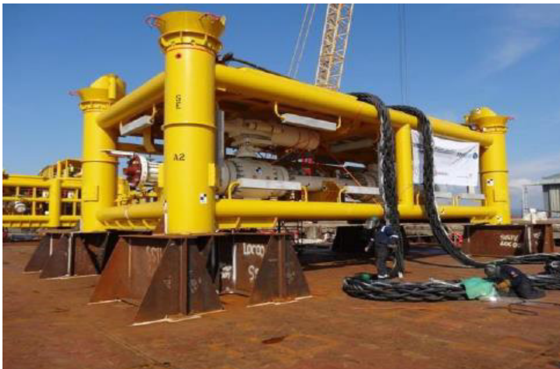
Рисунок 6 - Пример стального кондуктора для погружения свай
